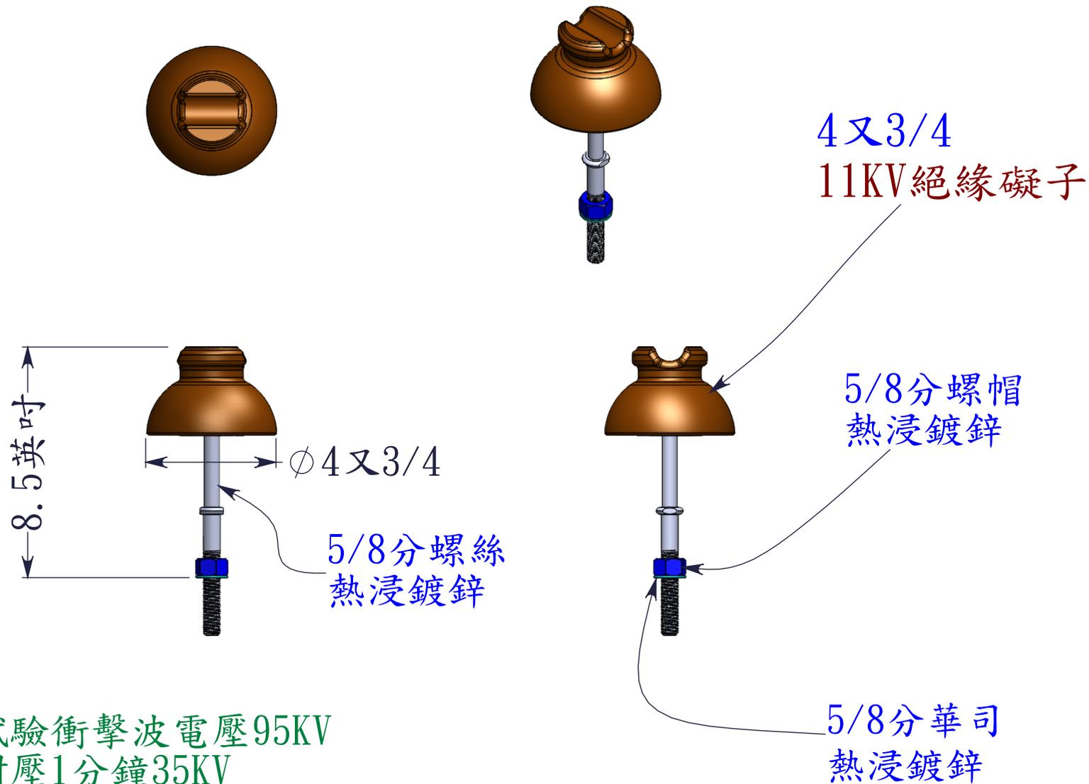
電氣試驗衝擊波電壓95KV
